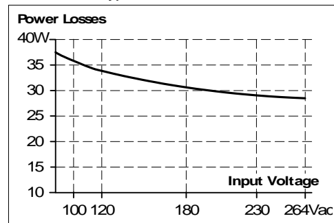
Bild 9-4 Verluste zu Eingangsspannung bei 12V, 30A, typ.
