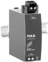
Das YR40.245 ist ein 40A-Einkanal-Redundanzmodul, das mit einem Steckverbinder am Ausgang ausgestattet ist. Der Steckverbinder ermöglicht den Austausch der Stromversorgung oder des Redundanzmoduls, während das System in Betrieb ist. Der Steckverbinder verhindert, dass die Ausgangsdrähte den Laststromkreis berühren und kurzschließen.
