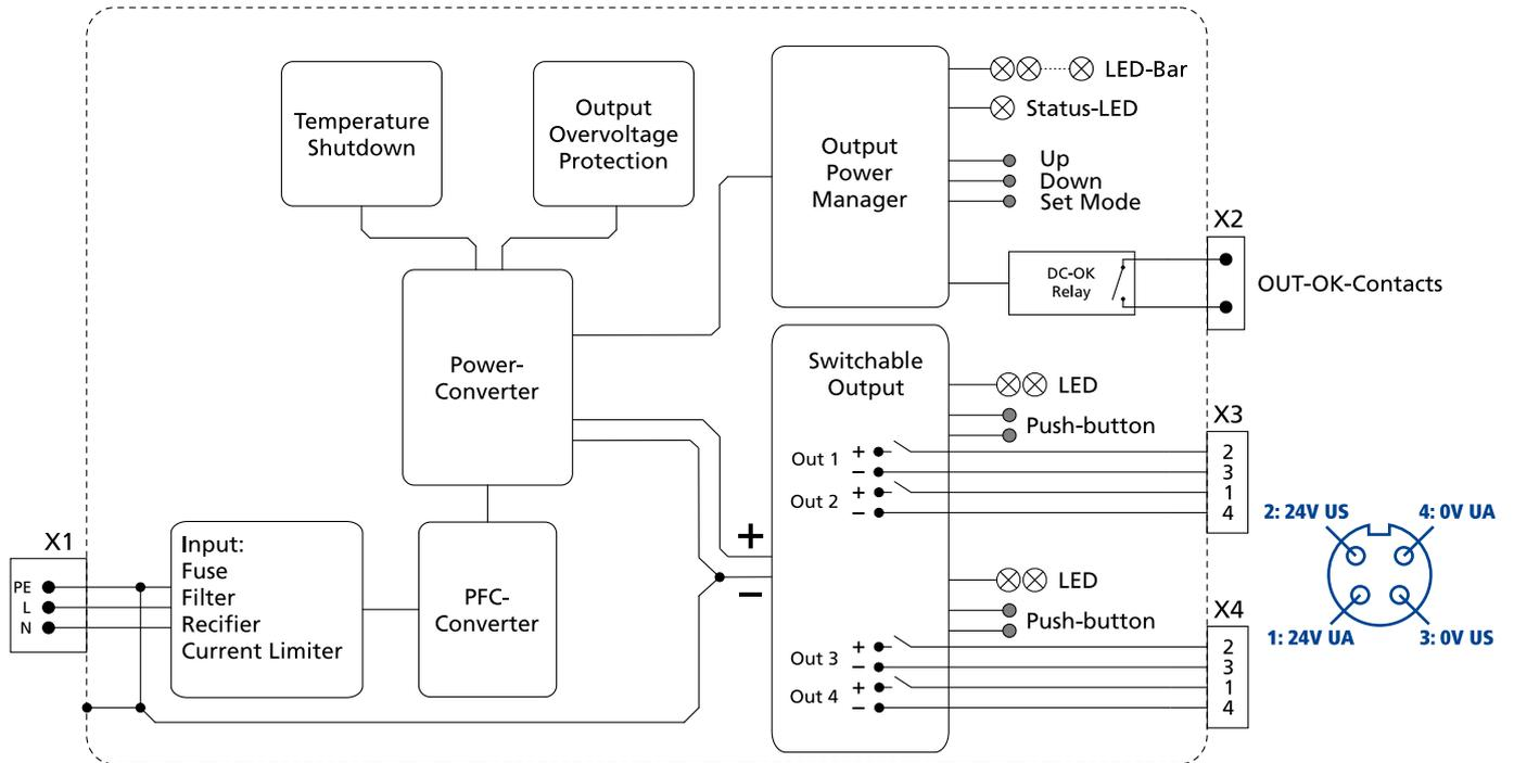
Fig. 12-1: Functional Diagram FPH500.245-047-104
