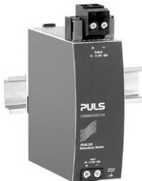
Das YR40.245 ist ein 40A-Einkanal-Redundanzmodul, das mit einem Steckverbinder am Ausgang ausgestattet ist. Der Steckverbinder ermöglicht den Austausch der Stromversorgung oder des Redundanzmoduls, während das System in Betrieb ist. Der Steckverbinder verhindert, dass die Ausgangsdrähte den Lastkreis berühren und kurzschließen.
