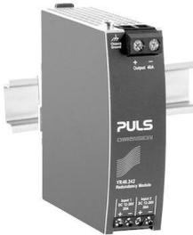
Das YR40.242 ist mit zwei Eingängen ausgestattet, die durch den Einsatz von Mosfet-Technologie einzeln entkoppelt sind. Der Einsatz von Mosfets anstelle von Dioden verringert die Wärmeentwicklung und den Spannungsabfall zwischen Eingang und Ausgang. Das YR40.242 benötigt keine zusätzliche Hilfsspannung und ist selbst bei einem Kurzschluss am Ausgang energieautark.
