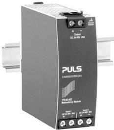
Das YR40.482 ist mit zwei Eingängen ausgestattet, die durch den Einsatz von MOSFET-Technologie einzeln entkoppelt sind. Der Einsatz von MOSFETs anstelle von Dioden verringert die Wärmeentwicklung und den Spannungsabfall zwischen Eingang und Ausgang. Das YR40.482 benötigt keine zusätzliche Hilfsspannung und ist selbst bei einem Kurzschluss am Ausgang energieautark.
