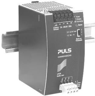
Dieses Puffermodul ist ein Zusatzgerät für DC 24V-Stromversorgungen. Es liefert Strom zur Überbrückung von Netzausfällen oder verlängert die Pufferzeit nach dem Abschalten der Netzspannung. In der Zeit, in der die Stromversorgung genügend Spannung liefert, speichert die Puffereinheit Energie in den integrierten Elektrolytkondensatoren. Bei einer Störung der Netzspannung wird diese Energie wieder zur Verfügung gestellt.
