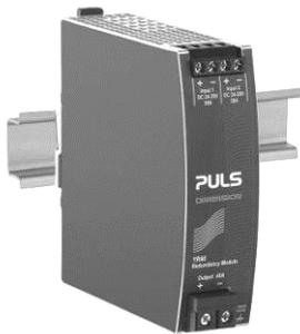
Das Redundanzmodul YR40.241 ist mit zwei Eingängen (jeweils 20A) ausgestattet, die durch den Einsatz von MOSFET-Technologie einzeln entkoppelt sind. Der Ausgangsstrom kann bis zu 40A betragen.
